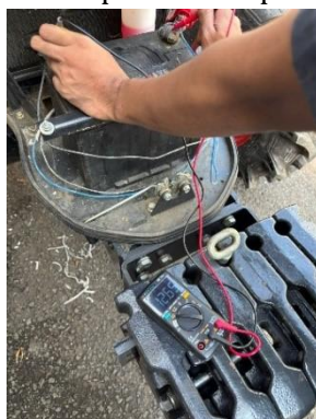
Gambar 5. Perbandingan Keluaran Data Tegangan dengan Multimeter
